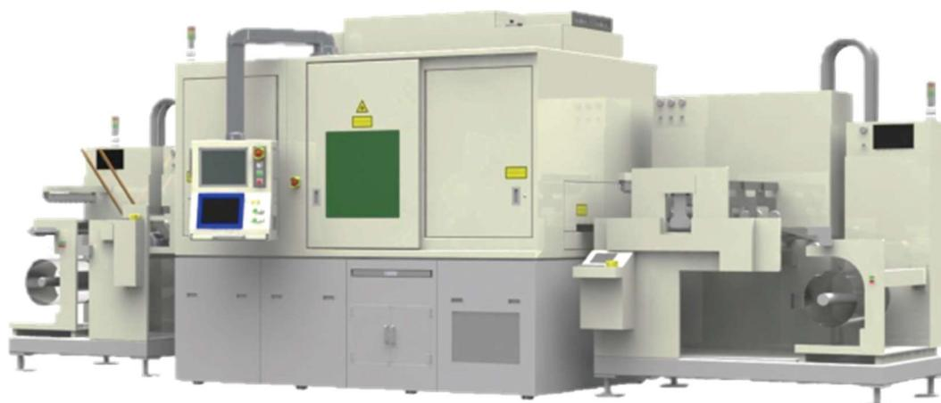
青色レーザー溶接装置では銅に対する吸収率が65%と高い青色レーザーによって、より深い溶け込みとスパッタフリーで安定した溶接を実現しています。レーザー加工は複雑微細な加工が金型なし、さらに薬品処理なしででき、環境負荷のきわめて少ない加工方法です。
